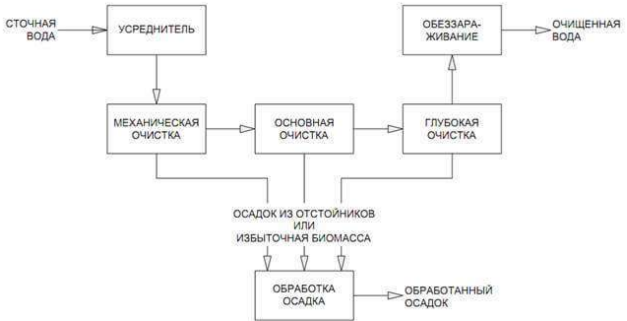
Рисунок 13 – Схема организации процесса очистки сточных вод
