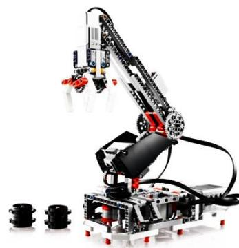
**Манипулятор** – механизм для управления пространственным положением орудий, объектов труда и конструкционных узлов и элементов.
