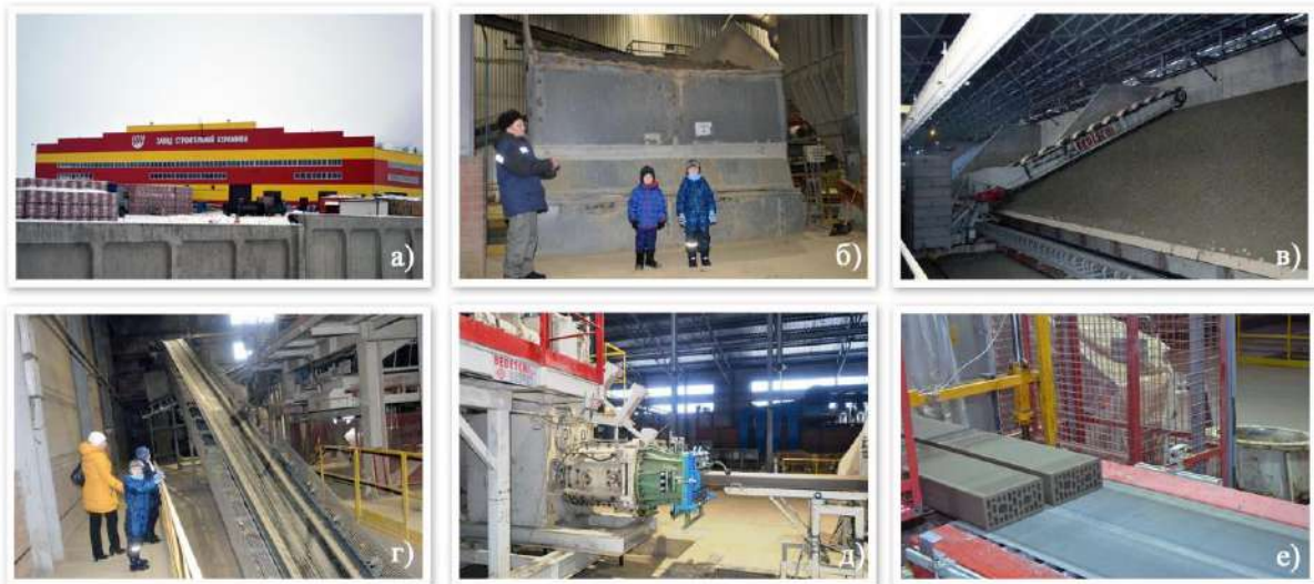
Рис.2. Экскурсия на заводе строительной керамики “Кетра”: а) внешний вид завода; б) бункер для хранения глины; в) глинохранилище; г) конвейер для подачи глины на пункт сортировки; д) формовщик глиняного пласта; е) устройство для нарезки кирпичей
